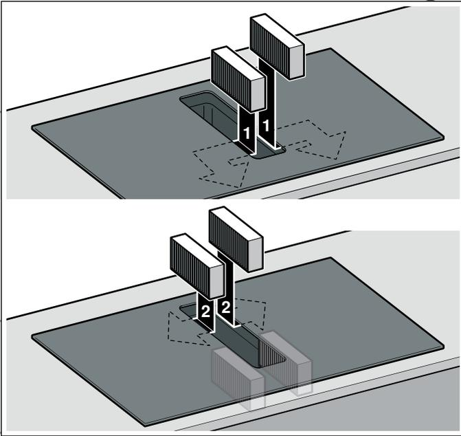
4. Die anderen Aktivkohlefilter oder Akustikfilter links und rechts in das Gerät einsetzen.
