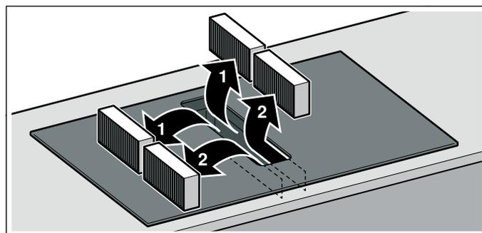
3. Zwei Aktivkohlefilter oder Akustikfilter links und rechts in das Gerät einsetzen und nach vorne schieben.
