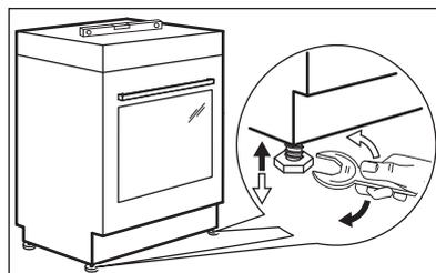
Richten Sie das Gerät mit den unten angebrachten Schraubfüßen so aus, dass sich die Oberfläche des Geräts auf einer Ebene mit den angrenzenden Oberflächen befindet.
