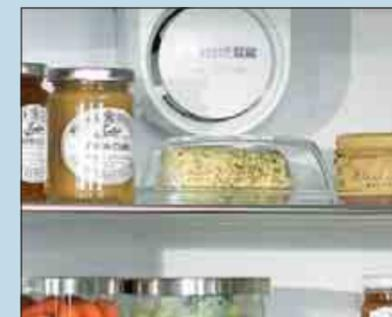
Das leistungsfähige **PowerCooling-System** sorgt für schnelles Abkühlen frisch eingelagerter Lebensmittel und eine gleichmäßige Kühltemperatur im gesamten Innenraum. Türkontaktschalter schalten den Ventilator bei Türöffnung ab. Dadurch wird wertvolle Energie gespart und das Einströmen von warmer Aussenluft verhindert.
