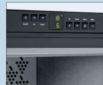
Die präzise **elektronische Steuerung** ist mit einer digitalen Temperatur-Anzeige ausgestattet. Die Temperaturen lassen sich im unteren Bereich zwischen +5 °C und +7 °C, im oberen Bereich zwischen +16 °C und +18 °C einstellen, dazwischen ergibt sich eine Temperatschichtung.
