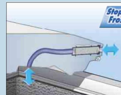
Das innovative **StopFrost** bietet zwei entscheidende Vorteile: Die Bereifung des Gefrierraums und des Gefrierbegriffs wird wesentlich reduziert, was das Abtauen viel seltener erforderlich macht. Außerdem entsteht nach dem Öffnen und Schließen des Truhendeckels kein Unterdruck mehr. Die Gefriertruhe kann mühelos geöffnet werden.
