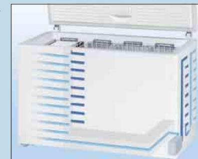
Der Verflüssiger für die Kälteerzeugung ist ringsum in die Außenhaut **glatt eingeschäumt**. Dadurch arbeitet das Gerät vibrationsarm und leise. Am Gehäuse bildet sich kein Schweißwasser, und die glatte Außenhaut lässt sich leicht reinigen.
