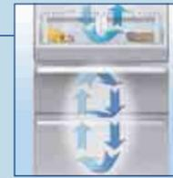
Mit zwei komplett getrennt regelbaren Kältekreisläufen kann mit **DuoCooling** die Temperatur bei Kühl-Gefrier-Kombinationen präzise und unabhängig im Kühl- und Gefrierteil geregelt werden. Zwischen Kühl- und Gefrierteil findet zudem kein Luftaustausch statt. Geruchsübertragung und Austrocknung der eingelagerten Lebensmittel wird somit verhindert.
